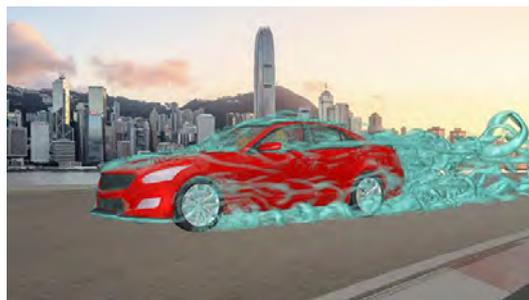
Abbildung 46: Gischtaufwirbelung an einem Fahrzeug. Simulationsergebnis [Siemens-2020].
